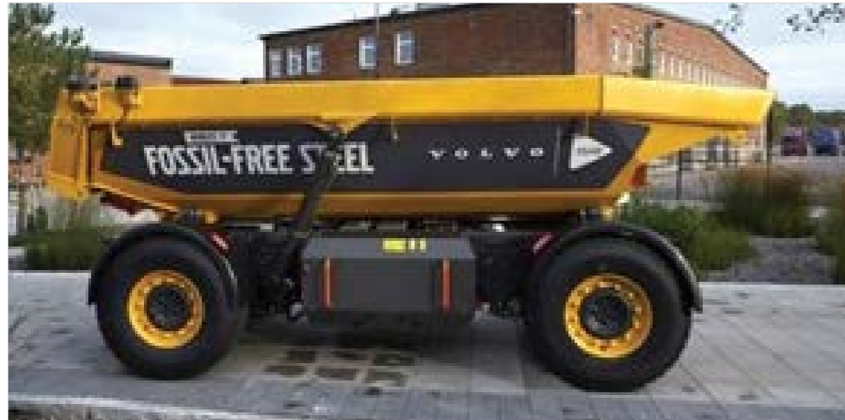
شکل ۳- اولین خودرو ساخته شده با فولاد حاصل از روش HYBRIT توسط خودروسازی ولوو.
